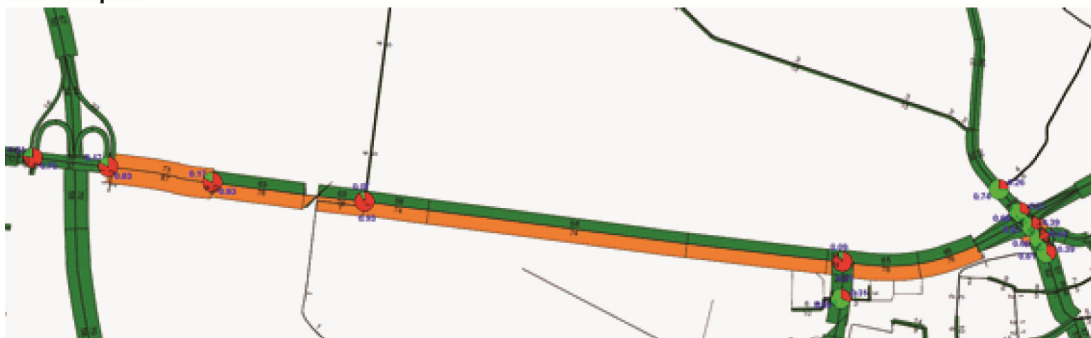
Figuur 2.3 IC-verhoudingen autonome situatie (cirkels geven cyclustijden weer)
