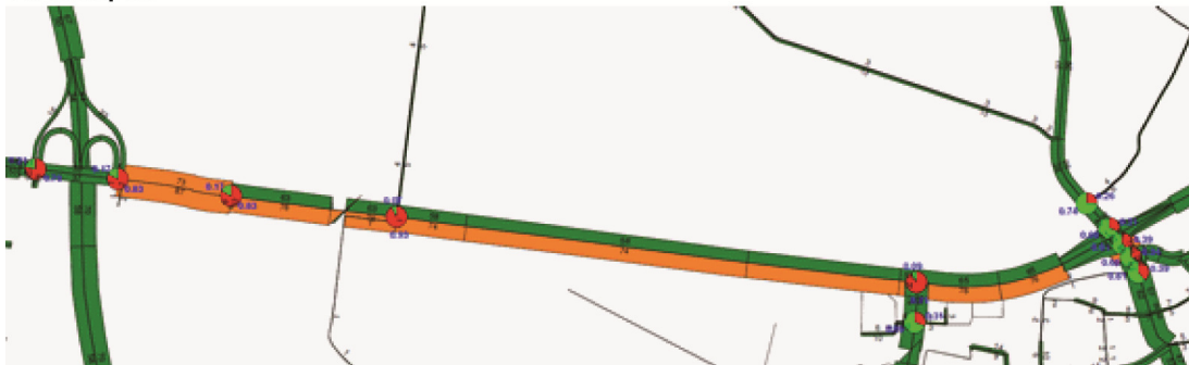
Figuur 2.3 IC-verhoudingen autonome situatie (cirkels geven cyclustijden weer)
