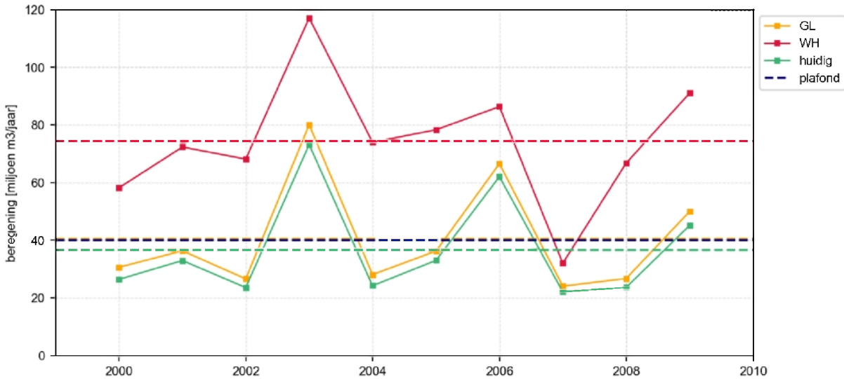
Figuur 3-6 Beregning per jaar bij huidig klimaat en scenario's G_L en W_H (berekend met Brabant model)
