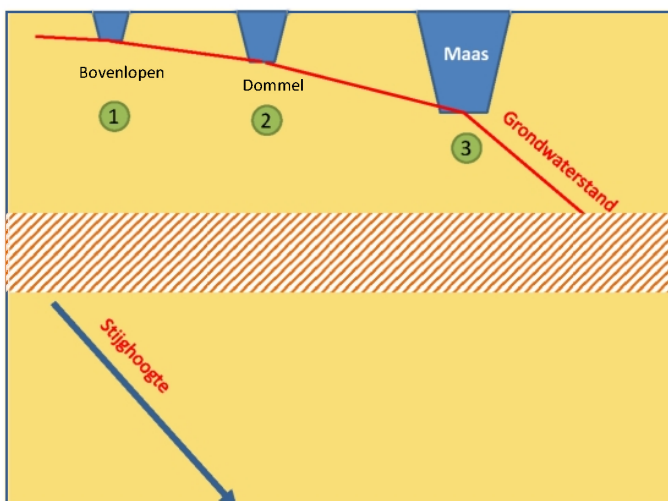
Figuur 6-7 Schematische weergave van uitputting van een grondwatersysteem
