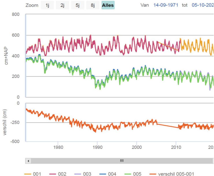
Figuur 3-18 Stijghoogte in de bovenste watervoerende laag boven (1 t/m 3 (roodpaars-oranje lijn boven) en onderste watervoerend pakket (4 t/m 7 blauw-groene lijn). Het stijghoogte- verschil tussen deze watervoerende pakketten (onderste lijn in figuur) is gestegen van 0,75 m in 1970 naar ruim 2,5 m vanaf 1990 (donker oranje lijn onder)
